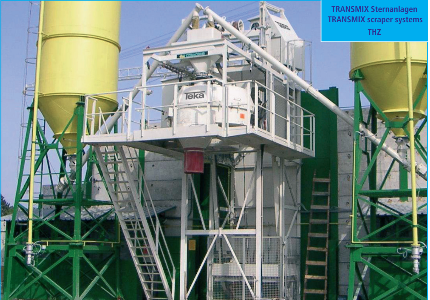
TRANSMIX THZ 750 - S 4 Sternanlage mit manuellem Schrapppwerk TS 12/13 • TRANSMIX THZ 750 - S 4 scraper system with manual scraper TS 12/13
