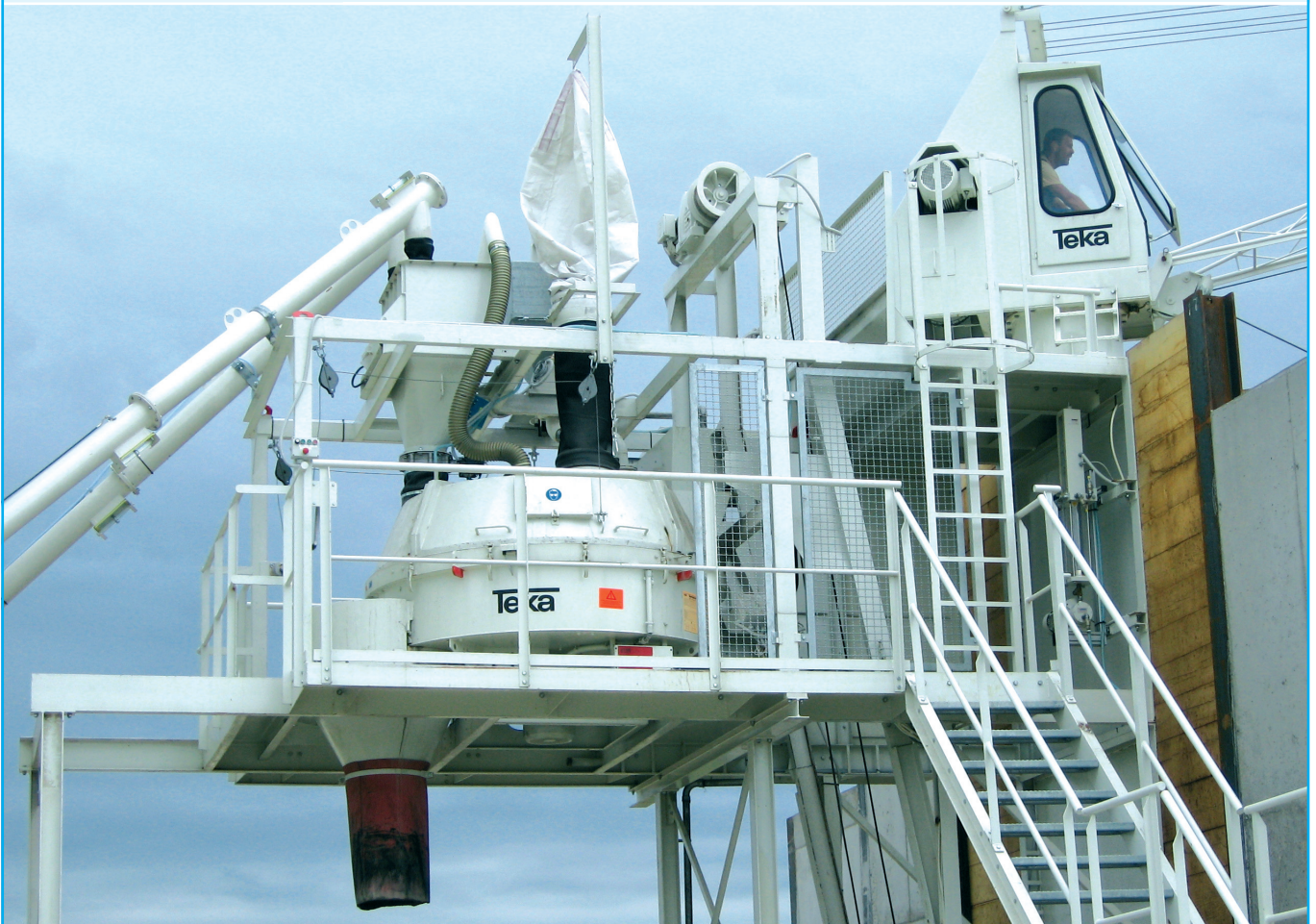
TRANSMIX THZ 750 - S 4 Sternanlage mit halbautomatischem Schräppwerk TS 40/20 • TRANSMIX THZ 750 - S 4 scraper system with semi-automatic scraper TS 40/20
