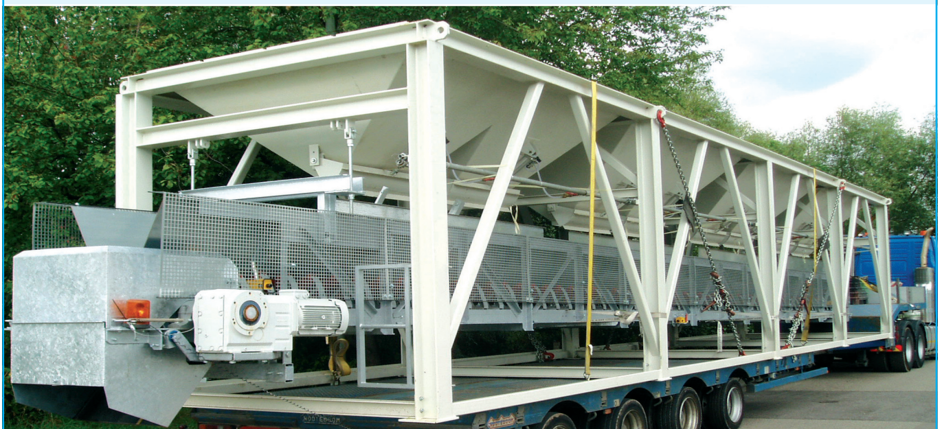
Reihensiloanlage - R 4, Verladung des Silounterteils • Aggregate in-line silo system - R 4, loading of a silo module
