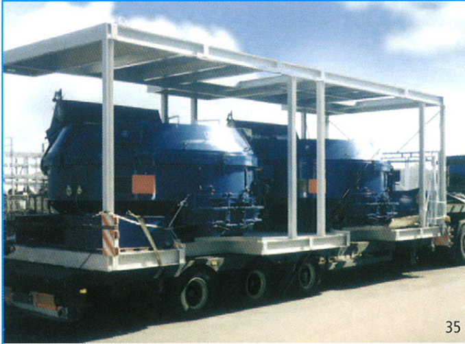
Bild 35: Anlieferung von vorgefertigtem Bauteil mit 2 Ringtrog-Mischern THZ 3000 / 2,0 m 3 . Bild 36, 37, 38: Montageablauf einer Mischanlage mit 2 Ringtrog-Mischern THZ 3000 / 2,0 m 3 und THZ 1500 / 1,0 m 3 . Bild 39, 40, 41: Montageablauf einer Mischanlage mit 2 Gegenstrom-Planeten-Mischern TPZ 2250 / 1,5 m 3 und TPZ 750 / 0,5 m 3 .
